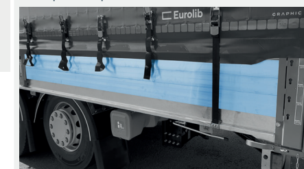
Stockage des lames en partie basse pour la position de route rehaussée
