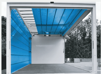
Portes latérales électriques se rabattant sous le toit
