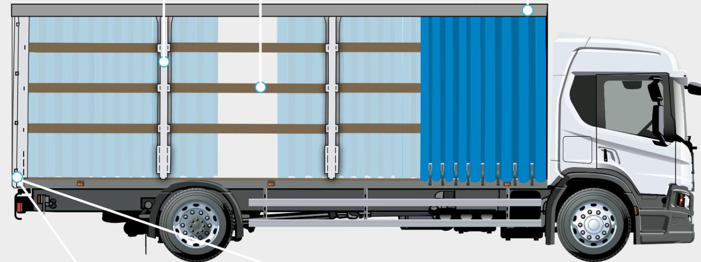
Planenspannung hinten mit Gelenkgriff-Schnellspanner
