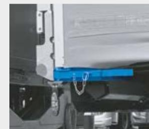
Planenspannung hinten mit Spannratsche
